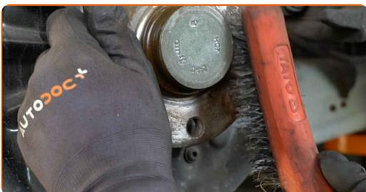
**22** Tratați suprafața de contact. Utilizați lubrifiant ceramic.
