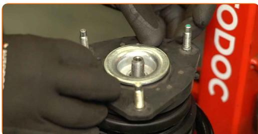
**62** Instalați și strângeți piulița tijei pistonului jambei. Utilizați un capăt de cheie tubulară pentru piulițele jambelor de 18 mm. Utilizați o bară de extensiune hexagonală H6. Utilizați o cheie dinamometrică. Cuplul de strângere: 70 N·m.
