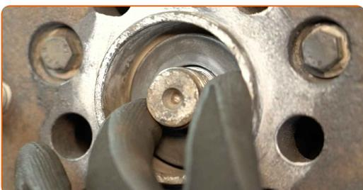
**71** Înșurubați piulița axului planetar. Utilizați un capăt de cheie tubulară de 36 mm. Utilizați o cheie cu clichet.
