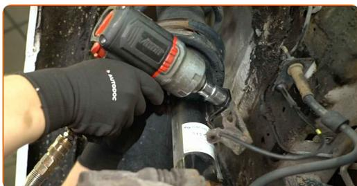
**22** Decuplați suportul cablului senzorului ABS de pe jamba suspensiei.
