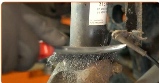
**21** Deșurubați elementul de fixare al suportului cablului senzorului ABS. Utilizați un capăt de cheie tubulară de 18 mm. Utilizați o cheie cu clichet.
