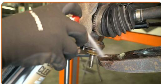
**73** Cuplați articulația sferică la brațul de comandă și înșurubați piulița de fixare. Utilizați o rangă de montaj.
