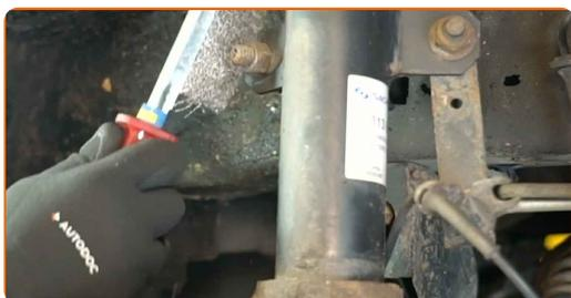
**19** Curățați elementul de fixare al suportului cablului senzorului ABS. Utilizați o perie de sârmă. Utilizați spray WD-40.
