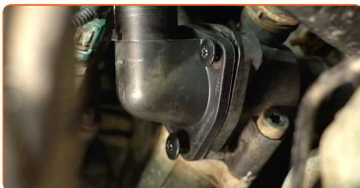
**20** Strângeți elementele de fixare ale capacului carcasei termostatului. Utilizați o tubulară cu bit Torx T30. Utilizați un prelungitor al capătului de cheie tubulară pentru crucea cardanică. Utilizați o cheie dinamometrică. Cuplul de strângere: 10 N·m.
