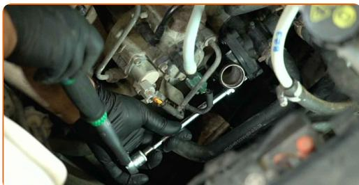
**21** Îndepărtați șervețelul din furtunul lichidului de răcire și reatașați-l. Utilizați cleștele pentru colierele de furtunuri.
