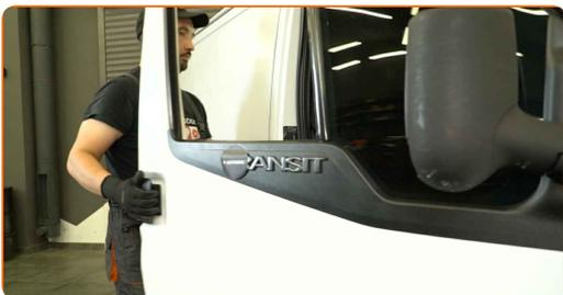
**2** Deșurubați elementele de fixare ale panoului portierei. Utilizați o șurubelniță cu cap în formă de cruce.
