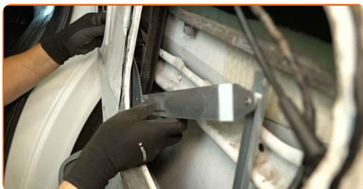
**21** Instalați șuruburile de fixare.
