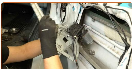
**20** Instalați un mecanism nou al ridicătoarei geamului.
