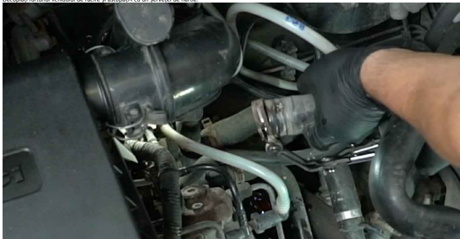
11 Curățați elementele de fixare ale capacului carcasei termostatului. Utilizați o perie de sârmă. Utilizați un spray de curățare polivalent.
