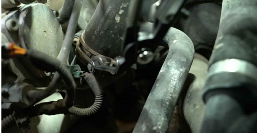
10 Decuplați furtunul lichidului de răcire și astupați-l cu un șervetel de hârtie.
