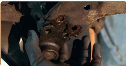
**63** Instalați șuruburile de fixare.
