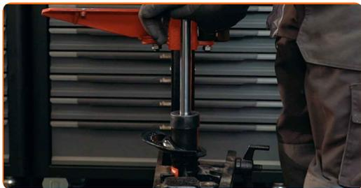
**43** Instalați scutul de protecție contra prafului și limitatorul de săgeată dinamică pe noul amortizor.
