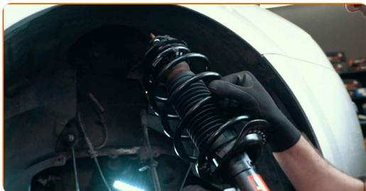
**53** Securizați elementele de fixare superioare ale telescopului amortizorului (3 bucăți). Nu îl strângeți.
