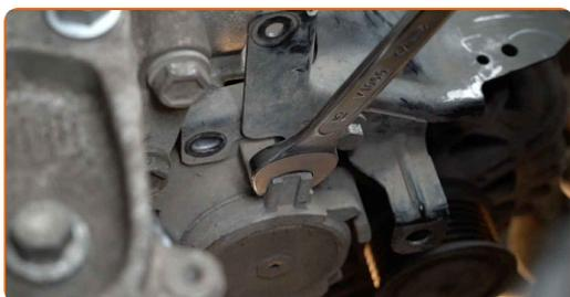
**112** Înșurubați elementul de fixare al rolei de întindere a curelei Poly-V. Utilizați o cheie tubulară №10. Folosiți o cheie cu clichet.
