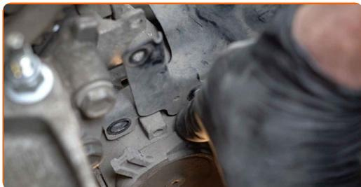
**110** Înșurubați elementele de fixare ale suportului cablajului alternatorului. Înșurubați elementele de fixare ale suportului cablajului alternatorului. Utilizați o cheie tubulară №10. Folosiți o cheie cu clichet.
