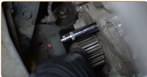
**72** Demontați pompa de apă. Folosiți o rangă.
