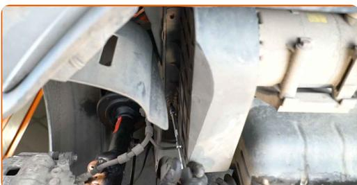
**10** Demontați capacul inferior al curelei Poly-V.
