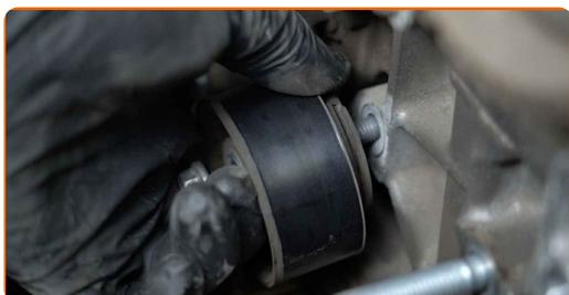
**71** Deșurubați elementele de fixare ale pompei de apă. Utilizați o cheie tubulară №8. Folosiți o cheie cu clichet.
