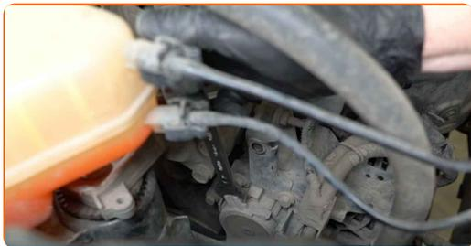
**14** Decuplați conectorul compresorului climatizorului.
