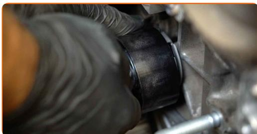
**79** Înșurubați elementul de fixare al rolei de întindere a curelei de distribuție. Utilizați o cheie în combinație fixă №13.
