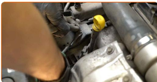
**20** Decuplați conectorul cablajului motorului.
