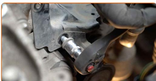
**111** Scoateți deoparte rola de tensionare a curelei de transmisie Poli-V. Utilizați o cheie în combinație fixă №15.
