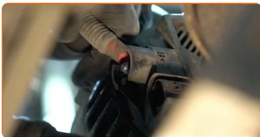
**19** Decuplați colierul cablajului alternatorului de la suport. Folosiți un clește pentru extras cleme.
