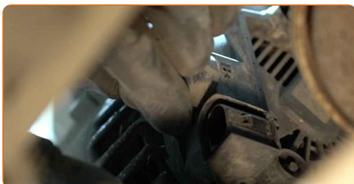
**17** Deșurubați dispozitivul de fixare al cablajului alternatorului. Utilizați o cheie tubulară №13. Folosiți o cheie cu clichet.
