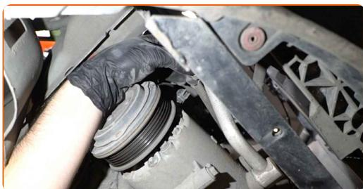
**15** Decuplați conectorul alternatorului.
