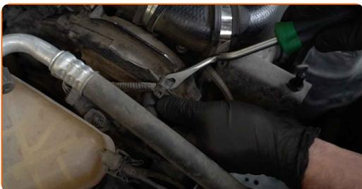
**7** Deșurubați elementele de fixare ale capacului superior al sistemului de distribuție. Utilizați o cheie tubulară №7. Folosiți o cheie cu clicet.
