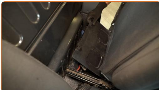
4 Deșurubați elementul de fixare al bornei negative a bateriei. Utilizați un capăt de cheie tubulară de 10 mm. Utilizați o cheie cu clichet.
