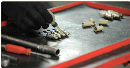
**9** Instalați noile bujii în locurile lor de montare. Folosiți o cheie tubulară pentru bujii #16.
