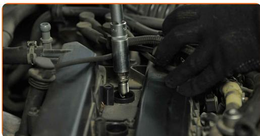
**10** Înșurubați noile bujii și strângeți-le. Folosiți o cheie tubulară pentru bujii #16. Folosiți o cheie de cuplu. Strângeți pînă la cuplul de 20 Nm.
