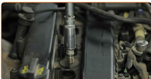
**11** Instalați conectorii firelor bujiei în locașul bujiei. Asigurați-vă că s-a produs un clic, care semnifică instalarea corectă în canelurile de fixare.
