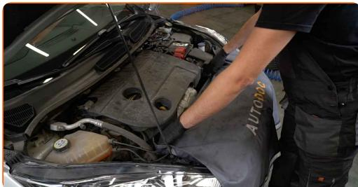
3 Deșurubați elementele de fixare ale terminalelor acumulatorului. Utilizați o cheie tubulară №10. Folosiți o cheie cu clichet.
