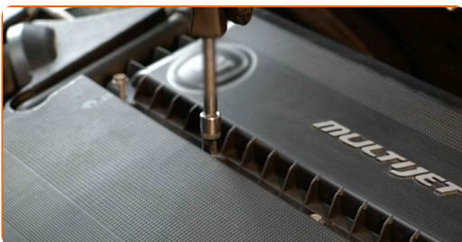
**4** Demontați capacul filtrului de aer.
