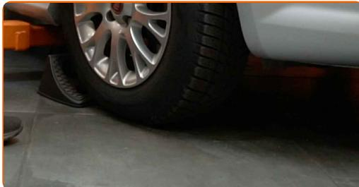
**3** Slăbiți șuruburile de fixare a roții. Folosiți o cheie tubulară de impact pentru roată #17.
