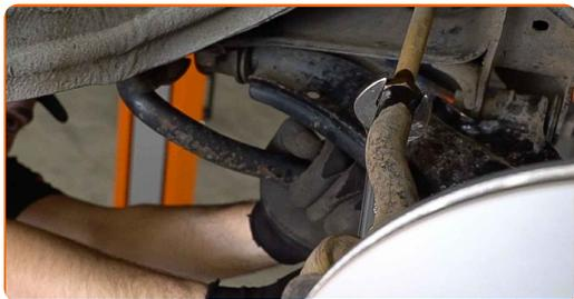
**9** Deșurubați piulița de fixare a capătului la fuzetă. Utilizați o cheie tubulară №17. Folosiți un port tarod.
