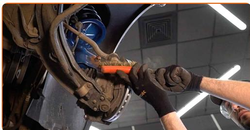
**7** Măsurați și memorizați locația exactă a articulației sferice pe tija de cuplaj sau numărați rotațiile complete pentru a evita o posibilă nealiniere în timpul montării succesive. Folosiți un șubler cu vernier.
