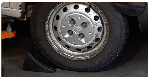
**2** Slăbiți șuruburile de fixare a roții. Folosiți o cheie tubulară de impact pentru roată #17.
