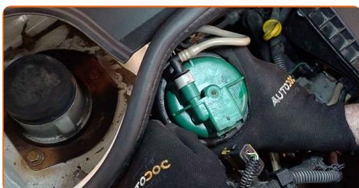
**13** Curățați conectorul senzorului de presiune a combustibilului. Folosiți spray pentru instalații electrice.
