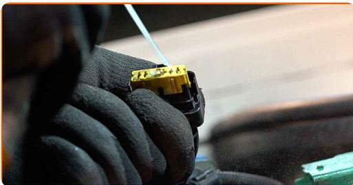
**14** Atașați conectorul senzorului de presiune a combustibilului.
