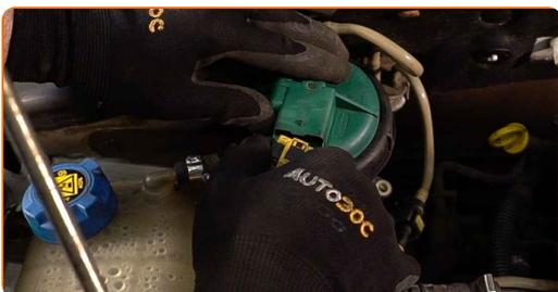
**4** Deșurubați capacul filtrului de combustibil.
