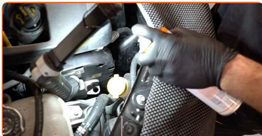
**11** Deșurubați capacul carcasei filtrului împreună cu elementul de filtrare vechi. Utilizați o cheie tubulară №27. Folosiți o cheie cu clichet.
