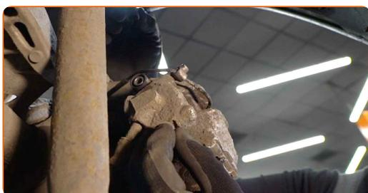
**28** Prelucrați șuruburile de fixare. Folosiți o perie de sârmă. Utilizați un agent de etanșare.
