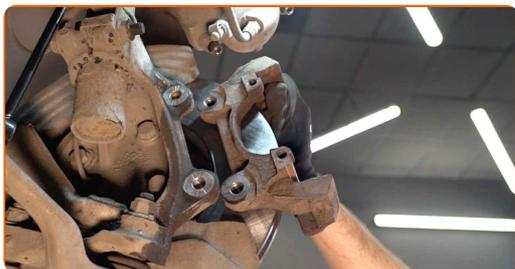
**30** Instalați șuruburile de fixare (2 bucăți).
