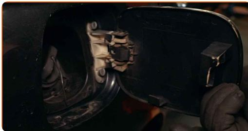
2 Deșurubați capacul filtrului de combustibil.
