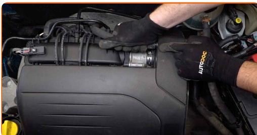
**4** Desfaceți clema ce prinde carcasa filtrului de aer a motorului de corpul clapetei de acceleratie. Folosiți o surubelnită dreaptă.
