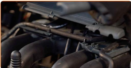
4 Scoateți conectorii cablurilor bujiei din locașul bujiei. Folosiți clești cu vârful rotund.
