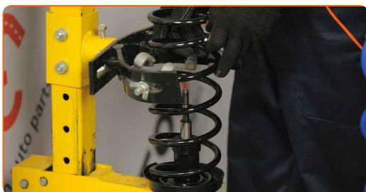
**28** Instalați scutul de protecție împotriva prafului și tamponul pe noul amortizor.
