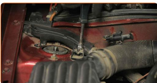
**15** Desprindeți cablajul motorului.
