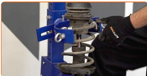
**21** Tratați tija telescopului amortizorului. Folosiți o perie de sârmă. Folosiți spray WD-40.
