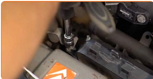
**12** Desfaceți bobina de inducție. Scoateți bobina de inducție din spațiul pentru bujii.
