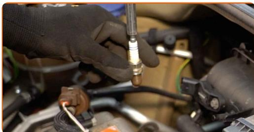
**16** Aplicați un strat subțire de pastă specială anti-gripantă rezistentă la temperaturi înalte pe filetul noilor bujii.
