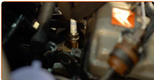
**18** Înșurubați noile bujii și strângeți-le. Folosiți o cheie tubulară pentru bujii #16. Folosiți o cheie de cuplu. Strângeți pînă la cuplul de 28 Nm.
