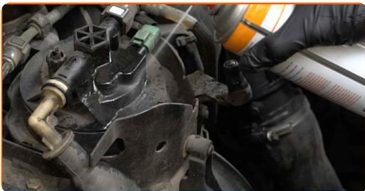
**5** Desprindeți conectorul senzorului de presiune a combustibilului. Folosiți o șurubelniță dreaptă.
