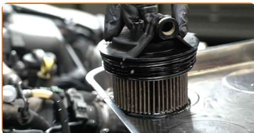
**12** Pompați combustibilul din carcasa filtrului de combustibil. Utilizați o seringă fluidă manuală.
