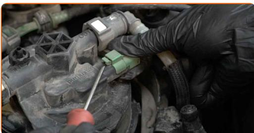
**6** Strângeți clamele și scoateți conductele de alimentare cu combustibil de la carcasa filtrului de ulei. Folosiți o șurubelniță dreaptă. Folosiți un clește pentru extras cleme.
