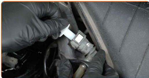
**8** Deșurubați elementele de fixare ale capacului carcasei filtrului de combustibil. Utilizați o cheie tubulară №27. Folosiți o cheie cu clichet.
