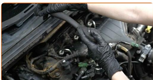
**9** Scoateți capacul filtrului de combustibil asamblat cu un cartuș de filtru vechi.
