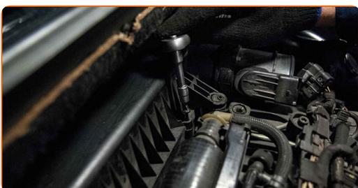
**10** Demontați capacul filtrului de aer.
