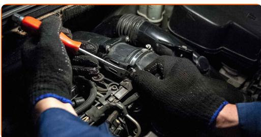
**9** Desfaceți șuruburile de pe capacul filtrului de aer. Folosiți o șurubelniță Phillips.
