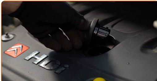
**4** Deșurubați filtrul de ulei. Folosiți o cheie tubulară pentru filtrul de ulei de 74/76-15F.
