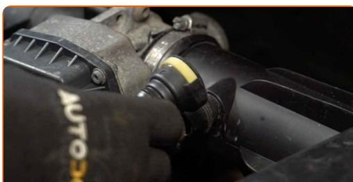
5 Deşurubați șuruburile de fixare ale carcasei filtrului. Utilizați o cheie tubulară №10. Folosiți o cheie cu clichet.
