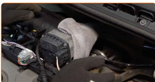
8 Desfaceți șuruburile de pe capacul filtrului de aer. Folosiți o șurubelnită Phillips.
