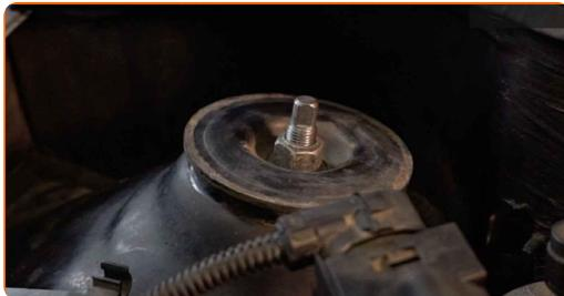
**4** Tratați tija telescopului amortizorului. Folosiți o perie de sărmă. Folosiți spray WD-40.
