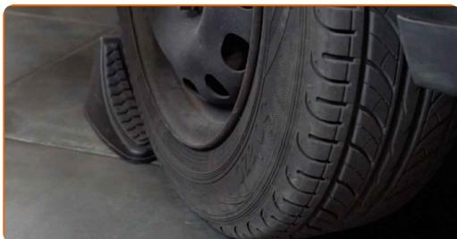
**7** Slăbiți șuruburile de fixare a roții. Folosiți o cheie tubulară de impact pentru roată #17.
