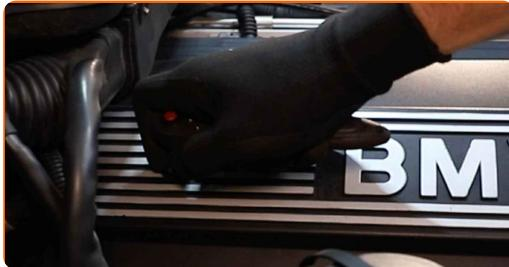
**6** Deșurubați bușonul de umplere cu ulei.
