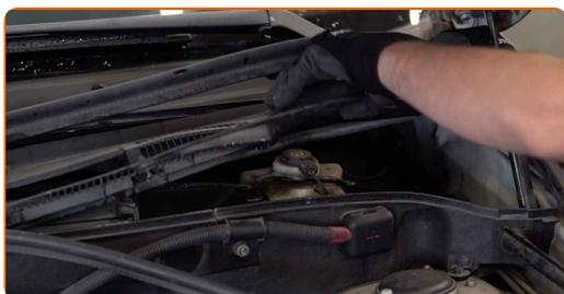
4 Deșurubați capacul rezervorului cu lichid de frână.
