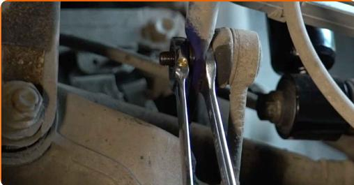
8 Deşurubaţi elementul de fixare ce uneşte bara stabilizatoare cu braţul de suspensie. Utilizaţi o cheie în combinaţie fixă №18. Folosiţi cheia hexagonală nr. H6. Folosiţi o cheie cu clichet.
