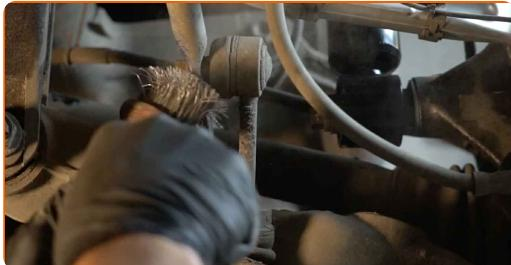
7 Deşurubaţi elementul de fixare ce uneşte bieleta antiruliu de bara stabilizatoare. Utilizaţi o cheie în combinaţie fixă №15. Utilizaţi o cheie în combinaţie fixă №16.
