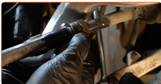
**9** Măsurați și memorizați locația exactă a articulației sferice pe tija de cuplaj sau numărați rotațiile complete pentru a evita o posibilă nealiniere în timpul montării succesive. Folosiți un șubler cu vernier.
