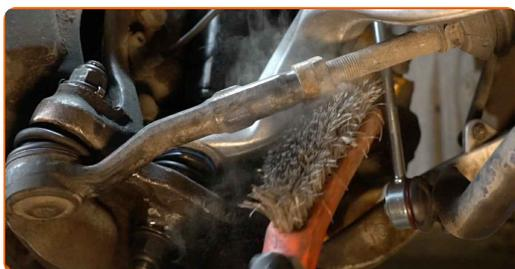
**7** Slăbiți contrapiulița de cuplare a capului barei de direcție pe tijă. Utilizați o cheie în combinație fixă №24.
