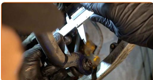
**10** Deșurubați piulița de fixare a capătului la fuzetă. Utilizați o cheie tubulară №21. Folosiți o cheie cu clichet.
