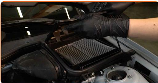
**9** Îndepărtați din carcasa filtrului elementul de filtrare care urmează să fie înlocuit.
