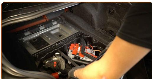
**40** Înșurubați elementul de fixare al panoului protector central din plastic. Folosiți o șurubelniță Phillips. Folosiți Torx T40. Folosiți o cheie cu clichet.
