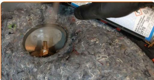
**28** Instalați dopul elementului de fixare de sus a amortizorului.
