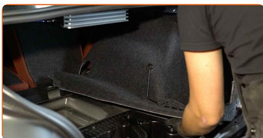
**38** Înșurubați elementul de fixare al căptușelii laterale a portbagajului. Folosiți Torx T40. Folosiți o cheie cu clichet.
