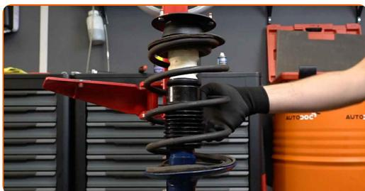
**38** Tratați locul de montare al telescopului amortizorului pe portfuzetă. Folosiți o perie de sârmă. Folosiți spray WD-40.
