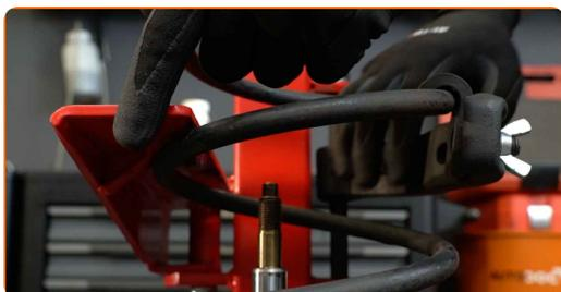
**31** Instalați scutul de protecție contra prafului și limitatorul de săgeată dinamică pe noul amortizor.
