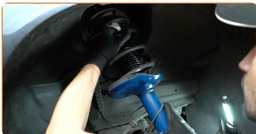
**40** Securizați elementele de fixare superioare ale telescopului amortizorului. Nu îl strângeți.
