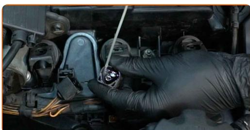
**15** Scoateți bobina de inducție din spațiul pentru bujii.
