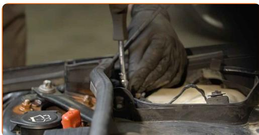
**9** Desprindeți conducta de cabluri din partea de sus a carcasei microfiltrului. Folosiți o șurubelniță dreaptă.
