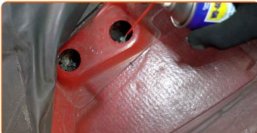
**4** Slăbiți elementul de fixare de sus al amortizorului. Utilizați o cheie tubulară №13. Folosiți o cheie cu clichet.
