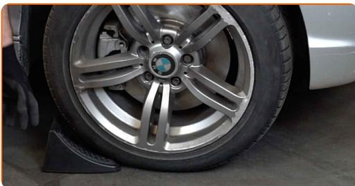
**4** Slăbiți șuruburile de fixare a roții. Folosiți o cheie tubulară de impact pentru roată #17.
