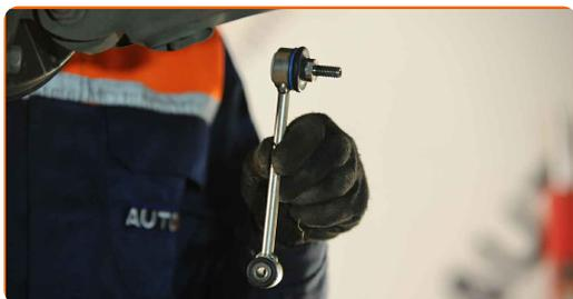
**13** Instalați suportul care fixează tija pe stabilizator și strângeți-l. Utilizați o cheie tubulară №13. Folosiți o cheie de cuplu. Strângeți pînă la cuplul de 21 Nm.
