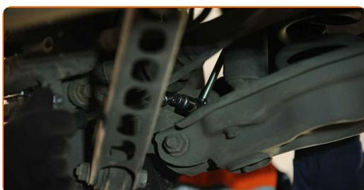
**14** Strângeți elementul de fixare ce unește bieleta antiruliu de bara stabilizatoare. Utilizați o cheie în combinație fixă №17 (2 bucăți). Folosiți o cheie de cuplu. Strângeți pînă la cuplul de 58 Nm.
