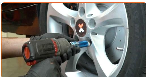
**39** Așezați din nou vehiculul la sol și, lucrând în ordine încrucișată, strângeți șuruburile de fixare ale roții. Folosiți o cheie tubulară de impact pentru roată #17. Folosiți o cheie de cuplu. Strângeți pînă la cuplul de 120 Nm.
