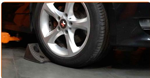
**6** Slăbiți șuruburile de fixare a roții. Folosiți o cheie tubulară de impact pentru roată #17.
