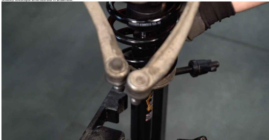
55 Instalați bara de sprijin amortizor sub arcul roți.
