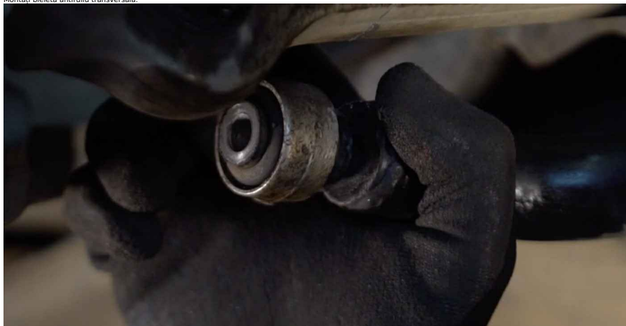
67 Strângeți elementul de fixare al bieletei antirulii.
