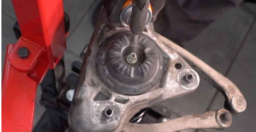
54 Scoateți telescopul amortizorului în ansamblu.
