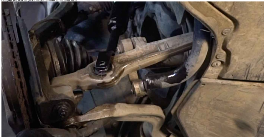
59 Instalați surubul de fixare.
