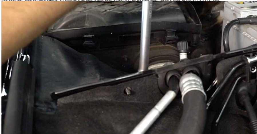
56 Înșurubați elementul de fixare superior al rulmentului de sarcină amortizor. Utilizați o cheie tubulară №16. Folosiți o cheie cu clichet. Nu îl strângeți.
