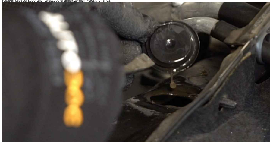
6 Săbiți elementul de fixare superior al suportului telescopului amortizor. Utilizați o cheie tubulară Nr.16. Folosiți o cheie cu clichet.
