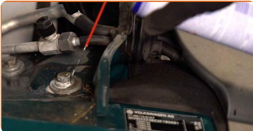
6 Slăbiți elementul de fixare superior al suportului telescopului amortizor. Utilizați o cheie tubulară №16. Folosiți o cheie cu clichet.
