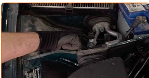
43 Curățați locurile de montare ale telescopului amortizorului. Folosiți o perie de sârmă. Folosiți spray WD-40.
