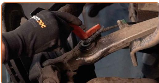
44 Atașați brațul de control al suspensiei la telescopul amortizorului.
