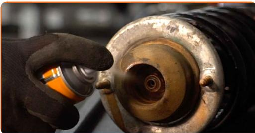
38 Instalați flanșa superioară a amortizorului împreună cu brațele de control.
