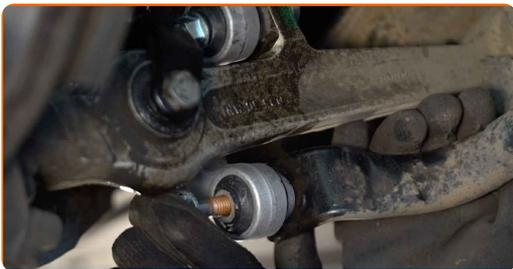
**12** Strângeți elementul de fixare ce unește bieleta antiruliu de bara stabilizatoare. Utilizați o cheie în combinație fixă №16. Utilizați o cheie tubulară №16. Folosiți o cheie de cuplu. Strângeți pînă la cuplul de 40 Nm.+90°
