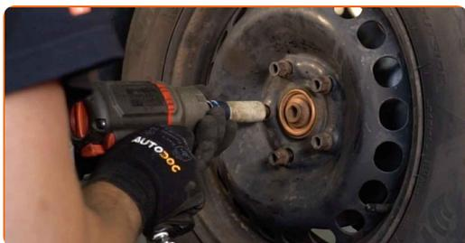
**19** Așezați din nou vehiculul la sol și, lucrând în ordine încrucișată, strângeți șuruburile de fixare ale roții. Folosiți o cheie de cuplu. Strângeți pînă la cuplul de 120 Nm.
