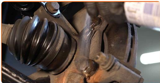
**14** Deșurubați fixarea suportului etrierului. Utilizați o cheie tubulară №18. Folosiți un port tarod. Folosiți o cheie cu clichet.
