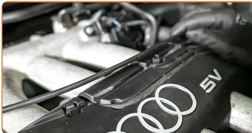
**4** Scoateți conectorii cablurilor bujieei din locașul bujieei.
