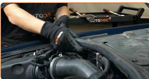
4 Deșurubați dispozitivele de fixare ale grilei de protecție din plastic a ștergătorului. Folosiți Torx T20. Folosiți o șurubelniță dreaptă.
