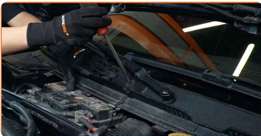
**14** Instalați și fixați grila de protecție a ștergătoarelor de parbriz. Folosiți Torx T20. Folosiți o șurubelniță dreaptă.
