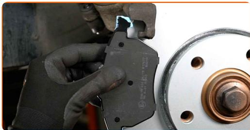
**27** Montați etrierul de frână și fixați-l. Folosiți cheia hexagonală nr. H7. Folosiți o cheie de cuplu. Strângeți pînă la cuplul de 30 Nm.
