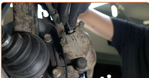
**29** Conectați senzorul de uzură al plăcuțelor de frână.
