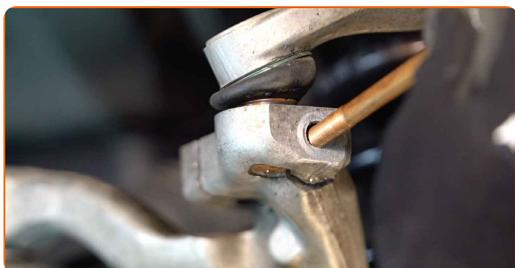
**58** Strângeți elementele de fixare ale pârgheii de control superioare (2 bucăți). Utilizați o cheie în combinație fixă №18. Utilizați o cheie tubulară №18. Folosiți o cheie de cuplu. Strângeți pînă la cuplul de 45 Nm.
