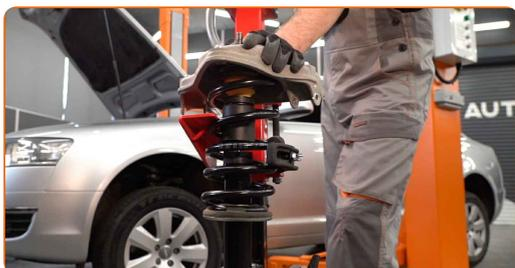
**41** Strângeți șurubul tijei pistonului barei de sprijin amortizor. Folosiți cheia hexagonală nr. H6. Utilizați o cheie tubulară №21. Folosiți o cheie de cuplu. Strângeți pînă la cuplul de 50 Nm.
