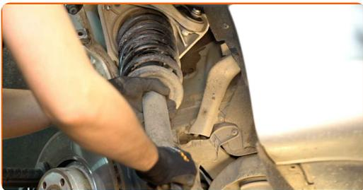
**26** Puneți semne pe brațele de control și pe flanșa amortizorului.
