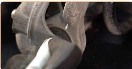
**27** Deșurubați elementele de fixare ce unesc brațele de control cu flanșa amortizorului. Utilizați o cheie în combinație fixă №18 (2 bucăți).
