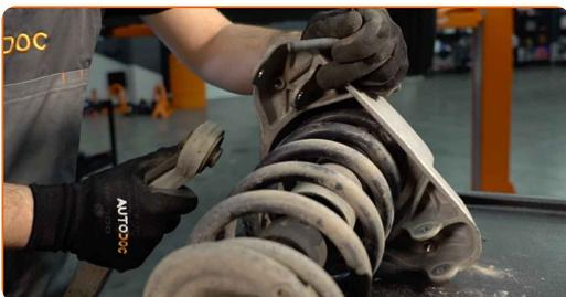
**29** Montați bara de sprijin amortizor pe dispozitivul special pentru comprimarea arcurilor.
