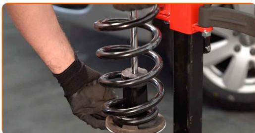
**38** Instalați scutul de protecție contra prafului și limitatorul de săgeată dinamică pe noul amortizor.
