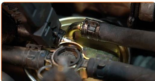
20 Strângeți clemele de fixare ale conductelor filtrului de combustibil. Folosiți un clește pentru coliere cu blocare.
