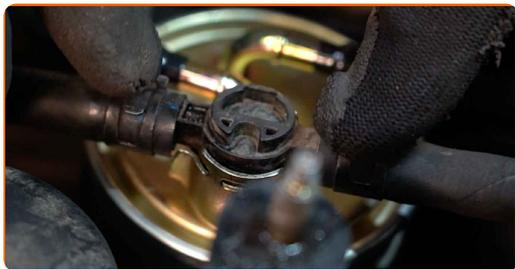
18 Instalați conectorul furtunului filtrului de benzină.
