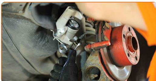
**17** Montați etrierul de frână și fixați-l.
