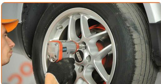
29 Așezați din nou vehiculul la sol și, lucrând în ordine încrucișată, strângeți șuruburile de fixare ale roții. Folosiți o cheie de cuplu. Strângeți pînă la cuplul de 120 Nm.
