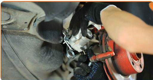
**18** Strângeți elementele de fixare ale etrierului de frână. Utilizați o cheie în combinație fixă №15. Utilizați o cheie tubulară №13. Folosiți o cheie de cuplu. Strângeți pînă la cuplul de 35 Nm.
