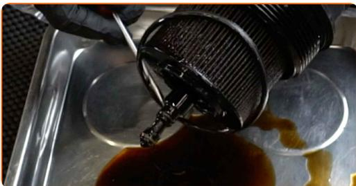
**15** Desfaceți filtrul de ulei de la capacul filtrului. Folosiți o șurubelniță dreaptă.
