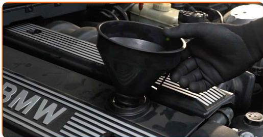
**28** Turnați uleiul în motor prin bușonul de umplere cu ulei. Cantitatea necesară de ulei: 6,5 l.
