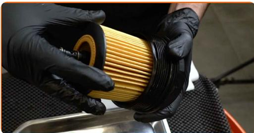
**18** Instalați un inel etanșator nou pe suportul acestuia de pe capacul filtrului.
