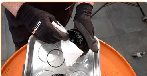
**15** Instalați un inel etanșator nou pe suportul acestuia de pe capacul filtrului.
